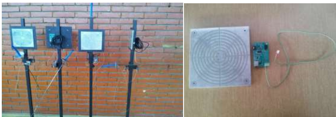
Снимка 2. Напълно окомплектовани мишени, свързани с оръжието; Снимка 3. Лицева страна на мишената с електронната платка, която се прикрепя към гърба и.
